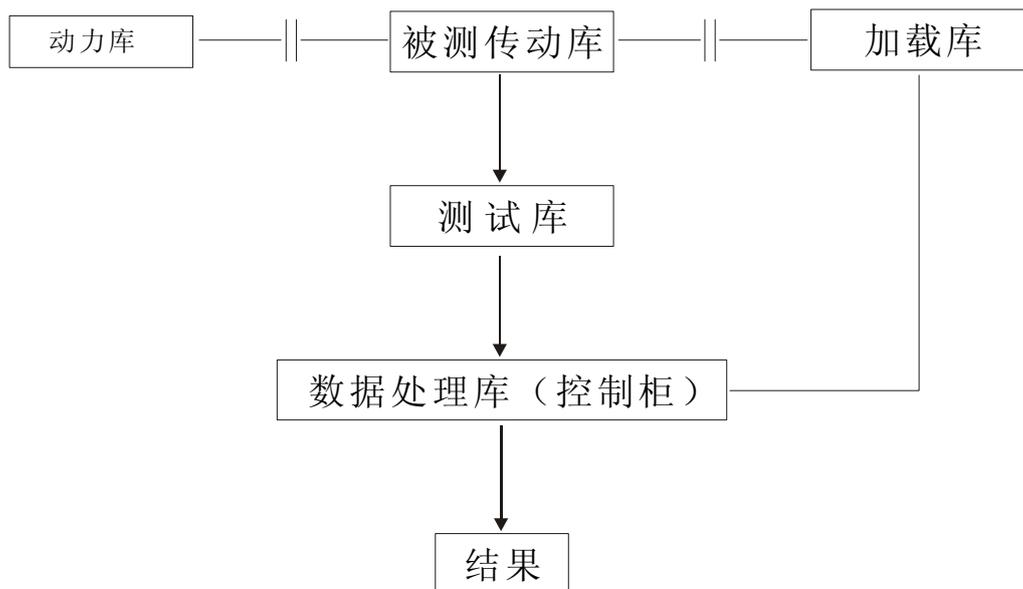
本试验台利用传动模块（库）中不同库件的选择及组合搭配，通过支承联接及调节模块的选择搭接，可构成三十余种单级及四级传动实验模式，其中包括 5 种单级典型机械传动实验模式，如：带传动试验台、链传动试验台、齿轮传动试验台、蜗杆传动（上置）试验台、蜗杆传动（下置）试验台，和十余种由带、链、齿轮、蜗杆等相互组合而成的多级组合机械传动系统试验台，如：带—齿轮传动试验台、齿轮—链传动试验台、带—链传动试验台、带—齿轮—链传动试验台、带—链—齿轮传动试验台等。
